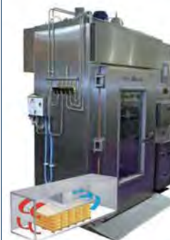
HORNOS PARA AHUMAR EN FRÍO Y EN CALIENTE CON FLUJO DE HUMOS
